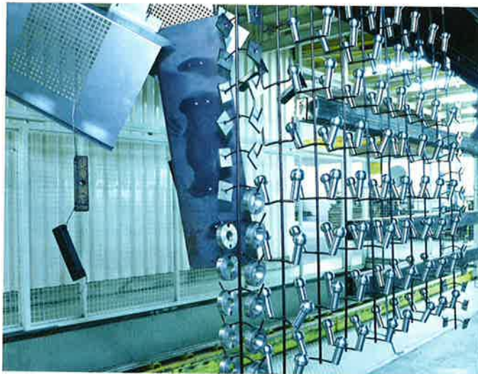
Vorbehandelte Anbauteile am P+F-Förderer befinden sich auf dem Weg zur Pulverbeschichtung.
